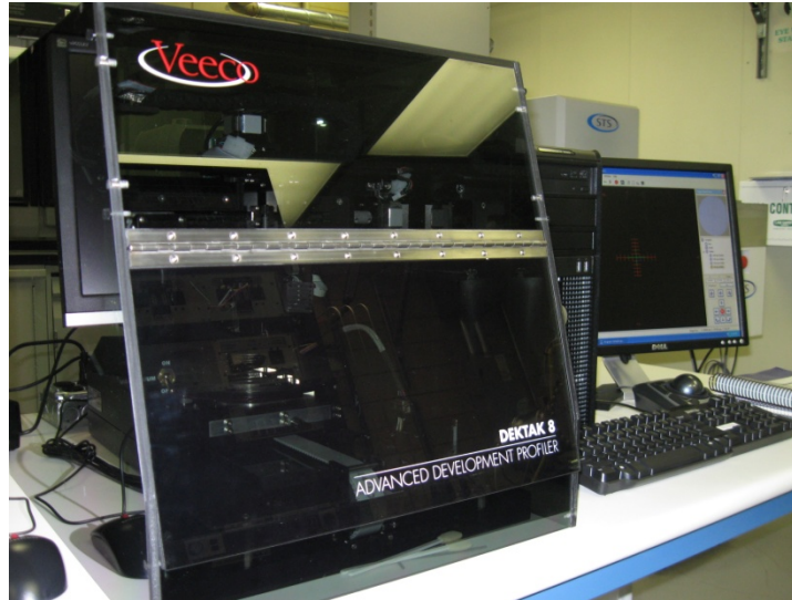
Figure 1: Dektak 8 Stylus Profilometer
